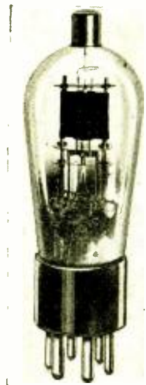
Fig. A The 55; Duplex-Diode Triode.
